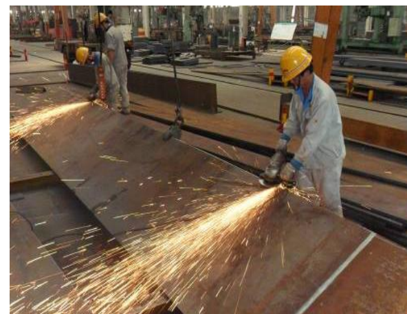
组装前坡口及周边打磨
